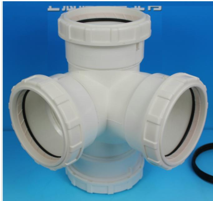
热熔承插式建筑排水用高密度聚乙烯[HDPE]排水管道系统防水步骤：1、需防水区域安装时管材外壁套一只和财牌专业密封圈，补洞时预埋在楼板混凝土中间，起到补偿管道因热胀冷缩而造成的渗水；2、按规范，水泥加堵漏王分层填实，密封圈埋中间，压实；3、采用弹性防水材料或沥青补偿，在管道（地面以上10cm）与地面（地面需干燥整洁无粉尘）交接处重复涂刷；4、穿楼板建议采用专有防水预埋套筒，一步解决，杜绝漏水；5、经养水试验确保无渗漏后方可交付使用；
